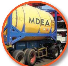
**MDEA** adalah cairan kuning jernih yang berfungsi sebagai bahan yang digunakan untuk proses pemurnian gas *Carbon Dioxide* ( $\text{CO}_2$ ) dan *Hidrogen Sulfida* ( $\text{H}_2\text{S}$ ) dalam industri pengolahan gas bumi.
